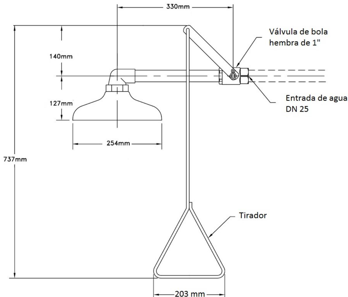
La ducha debe tener un flujo de agua de 76 litros por minuto entre 1,5 y 6,5 bares para funcionar correctamente. Por este motivo **es muy importante que las dimensiones de la tubería de entrada de agua se dimensionen correctamente teniendo en cuenta este dato**. No instalar la ducha si no se puede garantizar este flujo de agua.
