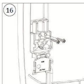
Fijar el conector rápido a la base del kit
