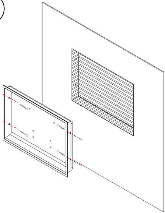
Posicionar el kit empotrado y fijar con 4 tornillos laterales
