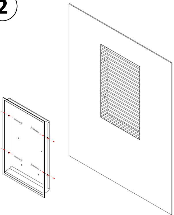
Posicionar el kit empotrado y fijar con 4 tornillos laterales
